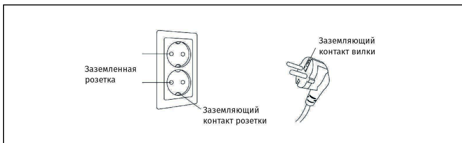
Рисунок 33 — Правильное заземление массажного кресла
